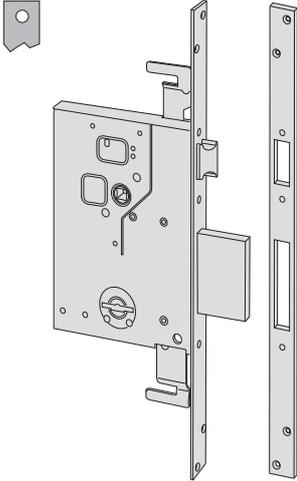
Grado 3 Seguridad de la norma europea EN 12209. Los dientes de arrastre de la palanca han sido diseñados para romperse en caso de intento de efracción. El dispositivo de bloqueo en la espiga está endurecido y redondeado térmicamente, para dificultar su perforación. El sistema de cifrado de las llaves con borjas independientes hace más difícil reproducir la combinación de la llave
